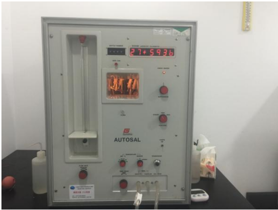
图 7、Autosal 8400B 型实验室高精度盐度计
