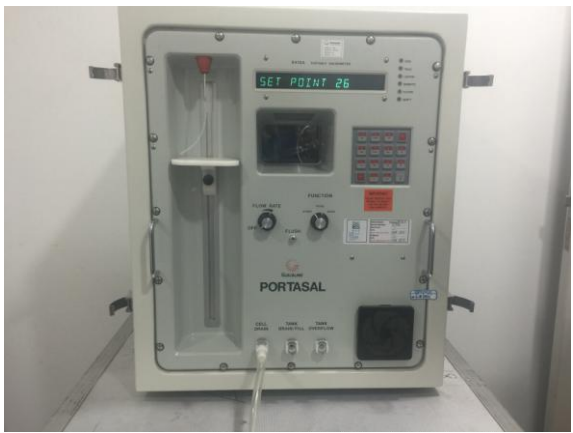
图 8、Portasal 8410A 型便携式精密盐度计
