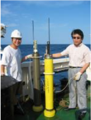
图 2 投放剖面浮标(左侧为国产,右侧为美国引进)
