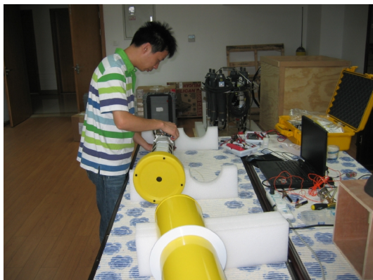
中心技术人员在加装锂电池
